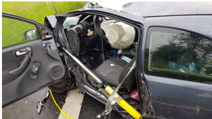
Einsatz eines hydr.Rettungszyinders an dem verunfallten PKW
